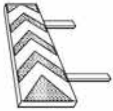
PANELES DIRECCIONALES PARA CURVAS
